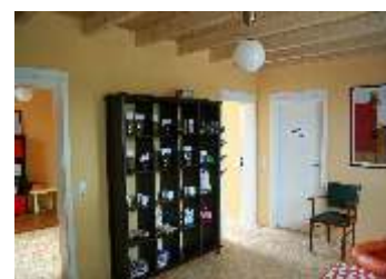
Diese Praxisräume wurden komplett im MAGU IN System erstellt, Auf die Behandlungszimmer wurde eine Holzbalkendecke als Raumabschluss gelegt - die Holzbalken wurden einfach in die MAGU IN Wand eingeschnitten.
